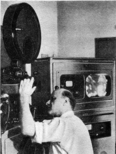
Bild 6. Von der ersten Vorführung des plastischen Roka-Kinne-Verfahrens im Fernsehstudio Berlin-Tempelhof. Auf dem Kontrollgerät des (links sichtbaren) Filmabtasters sind die beiden nebeneinander liegenden Teilbilder zu erkennen.
