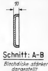
Bild 6. Stirn- und Mittelwände (zus. 3 Stück), genau in die Hauptwand Bild 5 passend, aus gleichem Werkstoff
